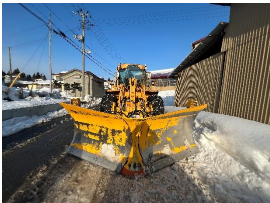
車道での除雪機の稼働
