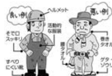
機械に巻き込まれない服装をする
