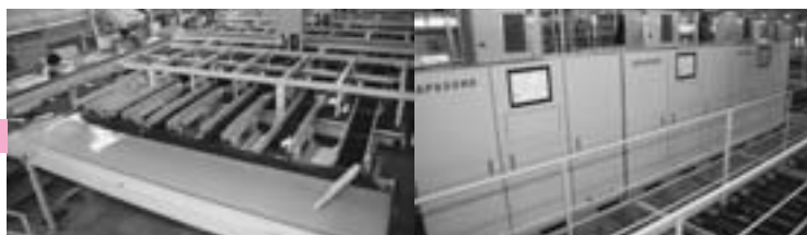
⑥形状判別・重量選別—形は形状判別装置（右）が自動で選別。重さは重量選別装置（左）が自動選別し、形や重さごとに箱詰めエリアへ流れる
