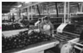
④洗浄機—5台の非接触式シャワー洗浄機から、ひげ根取り仕上げ洗浄機へ流れる
