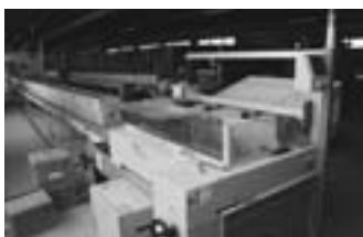
⑤空箱供給ライン（2階）—自動で作られた箱はコンベアで箱詰めエリアへ
