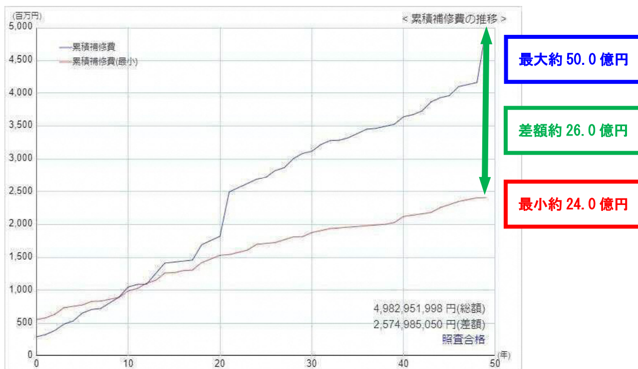
図6-1 全橋梁のLCC算定結果
